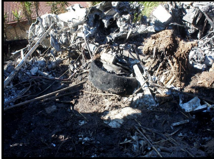
Fotografía No. 11 Tren de aterrizaje destruido por el fuego.
