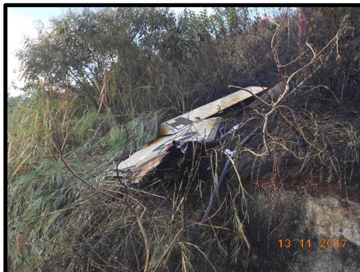
Fotografía No. 6 Vista del plano, el cual quedó separado por impacto.
