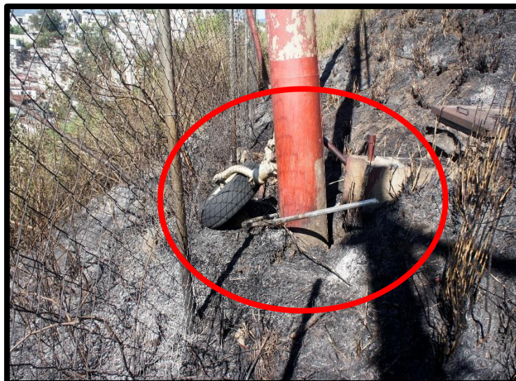
Fotografía No. 18 Base de los postes con muestras de daño por el impacto y tren de aterrizaje delantero separado del fuselaje.
