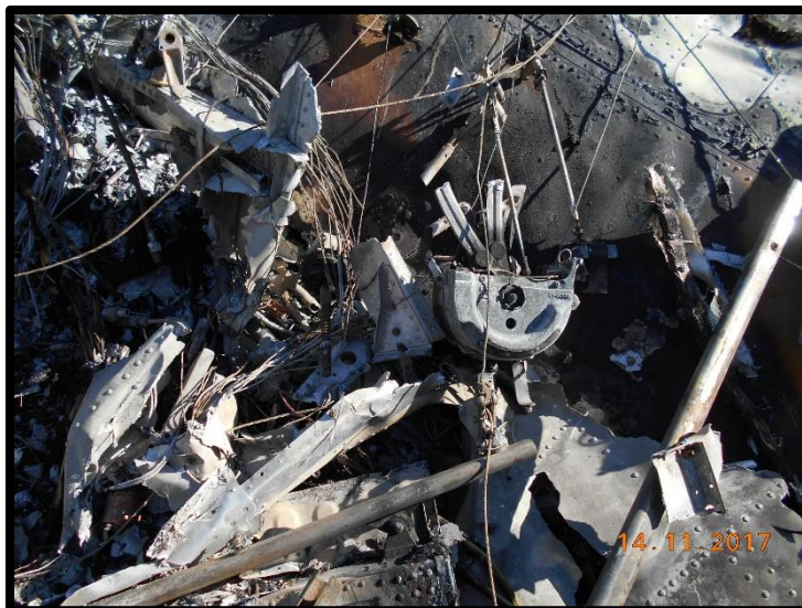
Fotografía No. 10 Cabina de mando destruida por el fuego.
