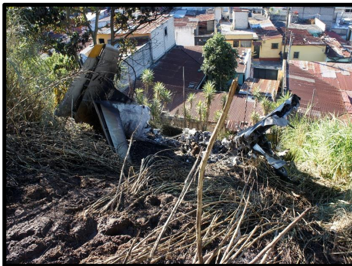
Fotografía No. 2 Fuselaje de la aeronave destruida por acción del incendio.
